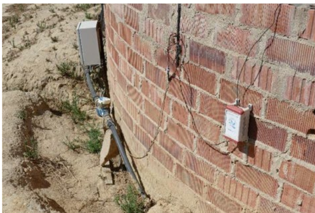
Imagen 2. Instalación con lectura automática y transmisión de datos en tiempo real en uno de los pozos integrados en el sistema "Doñana 4.0", de una de las explotaciones dedicadas al cultivo de frutos rojos (moras) en la Comunidad de Regantes de El Condado (Huelva).
