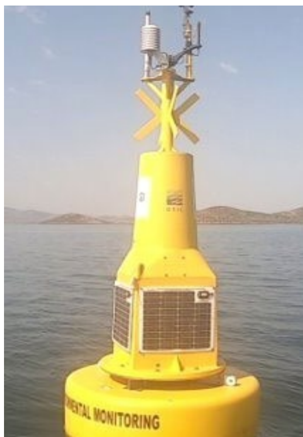
Boya piloto de monitorización SMARTLAGOON. Fuente: IEO-CSIC
