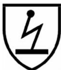
Ilustración 40: Pictograma de protección frente a electricidad estática en ropa de protección
