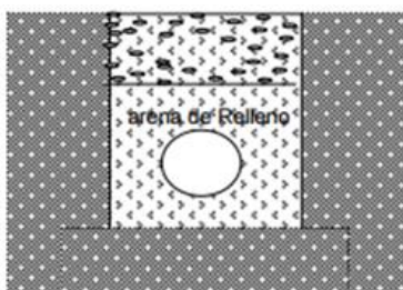
Ilustración 47: Tubo con recubrimiento de arena, resistencia a la compresión mínima 450 N
